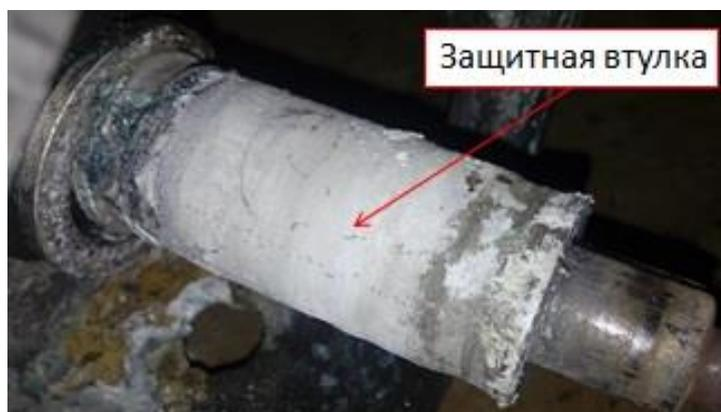
Рисунок 5.7 Фото изношенной поверхности защитной втулки
